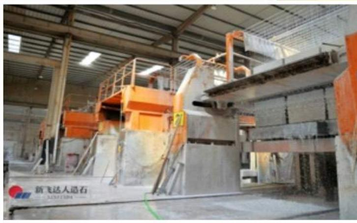
现有3条人造石生产线，拉锯8台、磨机2台、修边机1台、龙门吊2台、行吊13台、沙机2台、粉机1台、水石机1台、岗石压机3台、叉车3台、装载机1台、叉车7吨、10吨各一台等配套生产设备。
